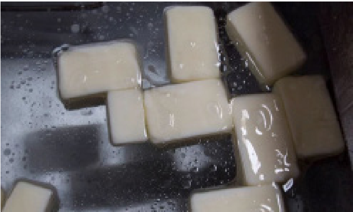
Fett som smälter i diskhoar innan det tappas ur, vid Mechlines testanläggning.
