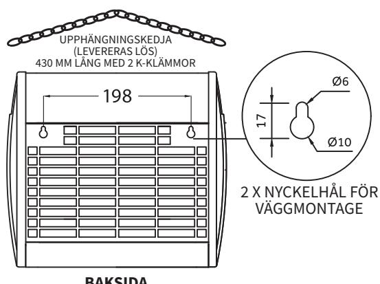
Mått anges i millimeter. För CAD-fil, vänligen besök [www.greasefix.se](http://www.greasefix.se).
